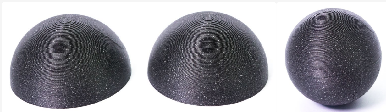
Tisk dvou polokoulí bez podpěr a jejich následné slepení.
