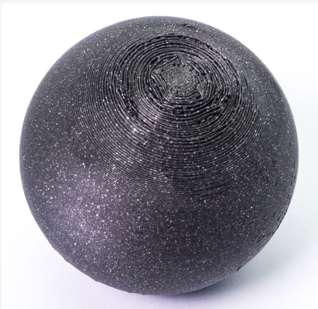
Tisk dvou polokoulí bez podpěr a jejich následné slepení.
