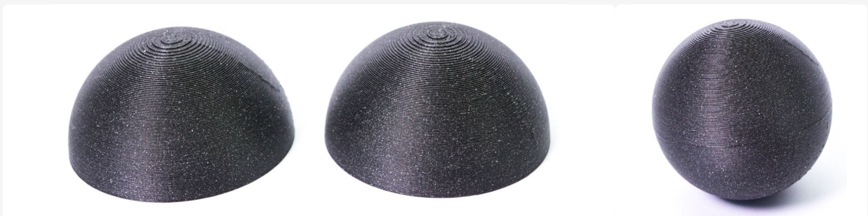
Drukowanie kuli przeciętej na dwie półkule, które zostaną sklejone po wydruku.
