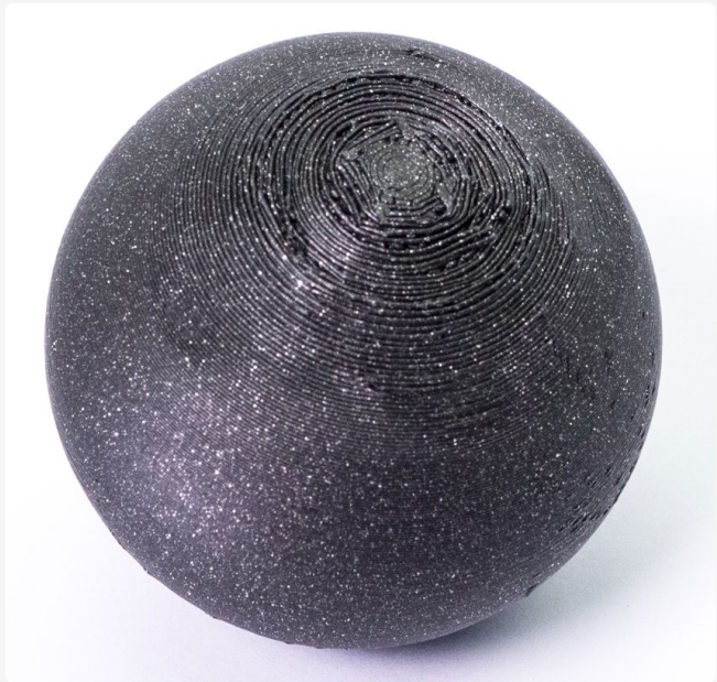
Drukowanie kuli przeciętej na dwie półkule, które zostaną sklejone po wydruku.
