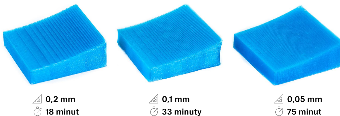
Jak wysokość warstwy wpływa na powierzchnię wydruku
