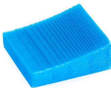
Wie sich die Schichthöhe auf die Oberfläche des Objekts auswirkt
