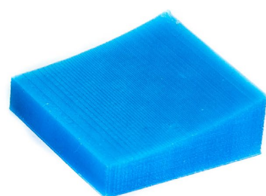
Wie sich die Schichthöhe auf die Oberfläche des Objekts auswirkt
