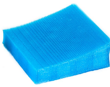
Wie sich die Schichthöhe auf die Oberfläche des Objekts auswirkt
