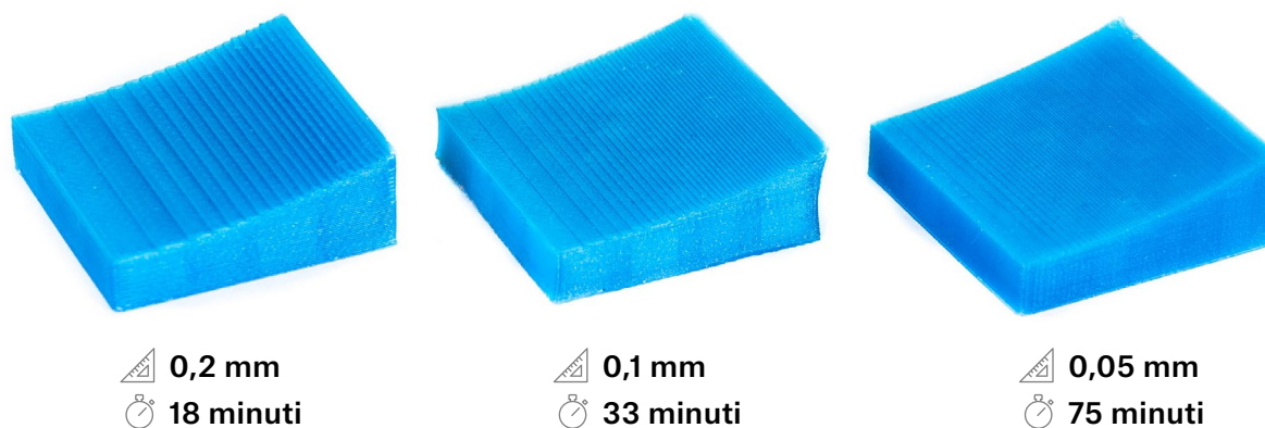
In che modo l'altezza degli strati influisce sulla superficie dell'oggetto
